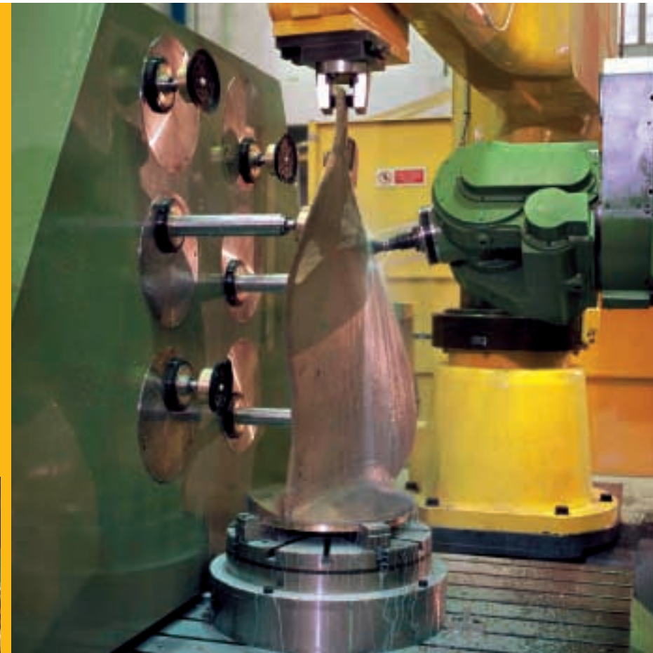
Il cantiere di Riva Trigoso (Ge) e sopra la lavorazione di una pala con un moderno centro di lavoro a cinque assi: il modulo Cam di Unigraphics NX ha permesso di ottenere un notevole boost prestazionale in fase di preparazione dei programmi e di realizzazione dei pezzi
